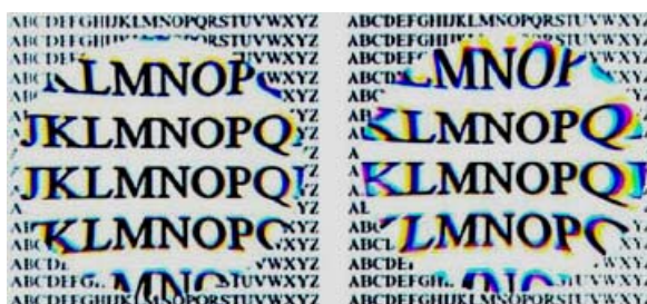
ภาพทางขวาแสดงความชัดใส ABBE 44 ของเลนส์ Trivex เปรียบเทียบกับความขุ่นของเลนส์โพลีคาร์บอเนต ABBE 31
